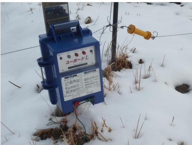
① 電気柵の点検。イノシシやシカが入ってこないように電気柵を設置しているが乾電池の能力が少なくなったので赤いランプがついている。取り換えて帰る。暗くなると電源が入る仕組みになっている。今の季節は夜が長いので電池の消耗も早い。
